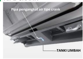
Menggunakan pipa pengangkut air tipe crank untuk mencegah luapan air limbah pada saat berkendara.
