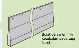
Menggunakan bentuk bulat dan bagian tepi karet memiliki ketebalan anti bocor yang berada di Tail gate untuk mengurangi bau dan luapan air limbah.
