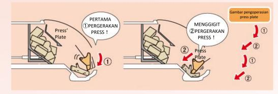
Pergerakan ① umumnya menggaruk sampah, tetapi kalau press platenya menggaruk benda keras secara otomatis arah menggaruknya berubah seperti pergerakan ② dengan power up. Sampah benda keras secara efisien dapat digaruk dan dipress dengan baik. Setelah itu jika berulangkali terjadi pergerakan ① dan ② maka dapat memuat sampah dengan efisien.
