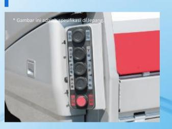
Pemasangan papan kontrol loading switch berada disamping hopper menghadap belakang dan miring kekiri. Ada kemungkinan pengoperasian dari sisi kendaraan, meskipun begitu pekerjaan dapat dilakukan dengan aman meskipun hopper dipenuhi dengan sampah.
