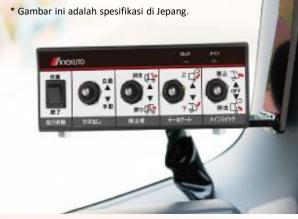
Perubahan bentuk tombol pengoperasian dalam kabin, tombol lampu telah menggunakan LED, dan ditingkatkannya visibilitas dan pengoperasiannya.
