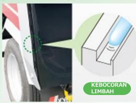
Pada stiffener bagian belakang body, menggunakan bentuk stiffener yang dapat mencegah luapan dan kebocoran air limbah.
